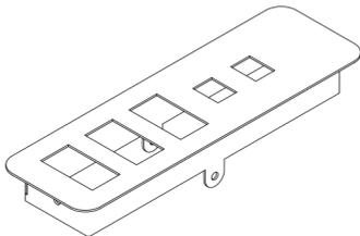
**Opções de furações para plug play:** 02x Elétrica 02x Elétrica + 01x Lógica 03x Elétrica + 01x Lógica 03x Elétrica + 02x Lógica 03x Elétrica + 03x Lógica 04x Elétrica + 01x Lógica 04x Elétrica + 02x Lógica 04x Elétrica + 03x Lógica 04x Elétrica + 04x Lógica
