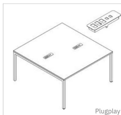
**Opções de furações para plug play:** 02x Elétrica 02x Elétrica + 01x Lógica 03x Elétrica + 01x Lógica 03x Elétrica + 02x Lógica 03x Elétrica + 03x Lógica 04x Elétrica + 01x Lógica 04x Elétrica + 02x Lógica 04x Elétrica + 03x Lógica 04x Elétrica + 04x Lógica\* \*Caixa de tomada padrão único
